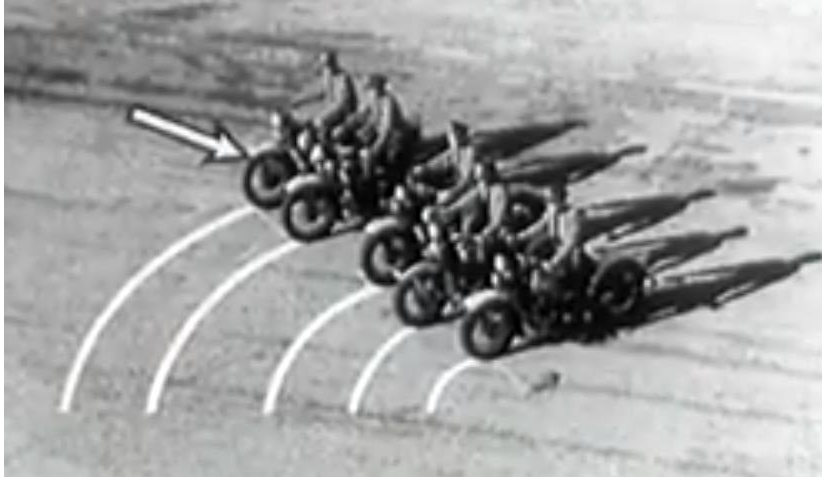
Şekil 1.2 Viraj esnasında iç ve dış tekerleğin kat ettiği yol
